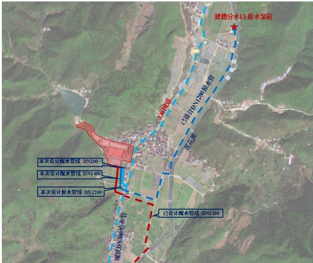
图 2-3 厂外原水管系统图
