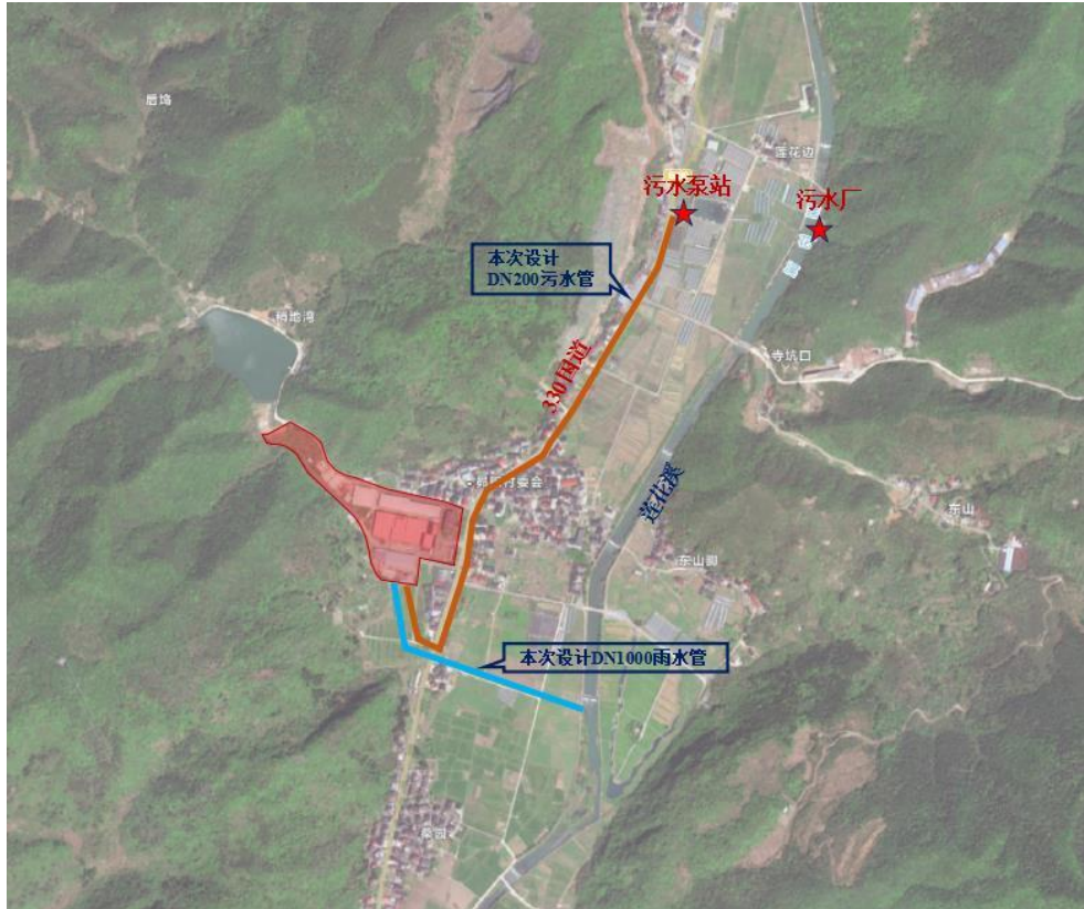
图 2-5 厂外排水管系统图
